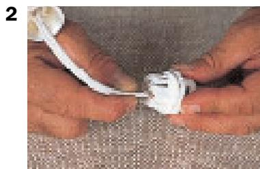
2. Les connexions sur les bornes sont réalisées par enfoncement dans les trous des bornes, sans vissage.
