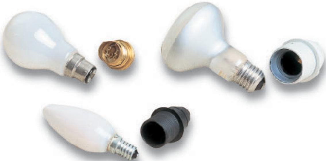
Une douille est destinée à recevoir et alimenter une ampoule. On utilise essentiellement trois types de douilles : les douilles B 22 pour lampes à culot baïonnette, les douilles E 27 pour lampes à culot à vis et les douilles E 14 pour lampes à culot à vis de petit diamètre.
