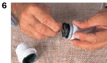
5. Certains modèles de douilles à vis sont à connexion automatique sans vis. Torsader parfaitement le fil et l'insérer "en force" dans la borne de connexion.
