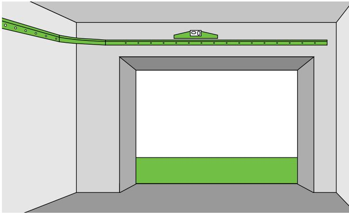
Fixer le rail de guidage en façade et en retour à l'aide des fixation fournies. Vérifier son horizontalité avec le niveau.
