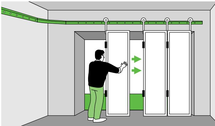
Suspendre les vantaux et les assembler entre eux (articulation).
