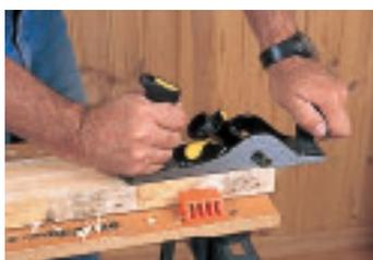
8. Raboter en appuyant régulièrement, dans le sens du fil et dans un mouvement continu.
