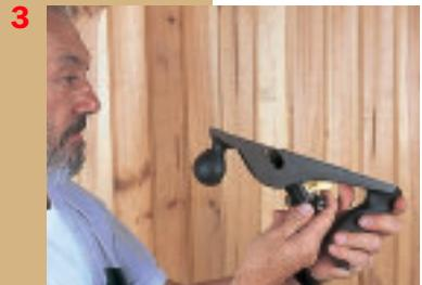
**3. La lame doit sortir de 2 à 5 dixièmes de millimètre, en restant parallèle à la semelle de l'outil. Contrôler le réglage à l'œil...**
