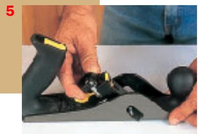
**5. Pour "donner du fer" (sortir la lame), tourner le bouton moleté dans le sens des aiguilles d'une montre. Pour "retirer du fer" (rentrer la lame), tourner le bouton dans l'autre sens.**
